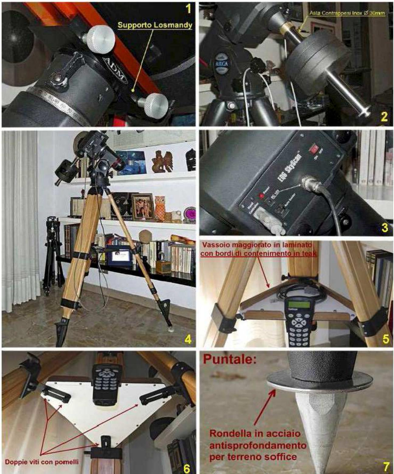
Possiedo una montatura EQ6 SkyScan e, per ottimizzare al meglio il sistema treppiedi-montatura-ottica per l'utilizzo in astrofotografia, sono intervenuto sia sull'accoppiamento con il tubo ottico sostituendo la slitta portastrumenti con quella ad attacco Losmandy dell'ADM (Fig.1), sia sull'asta dei contrappesi in
